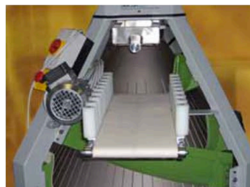
Arrotondatrice conica con tappeto in uscita Conical rounder with exit conveyor belt
